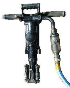
ハンド削岩機 (ジャックハンマー)
